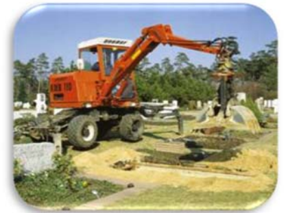
Bild rechts: Abstützung eines Grabbaggers durch schwenkbare Hydraulikstützen
