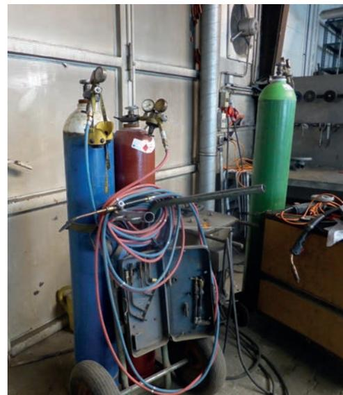
Auch die Gasschläuche sind regelmäßig einer Sichtprobe zu unterziehen. Sind sie brüchig geworden oder mechanisch beschädigt, gehören sie ausgetauscht.
