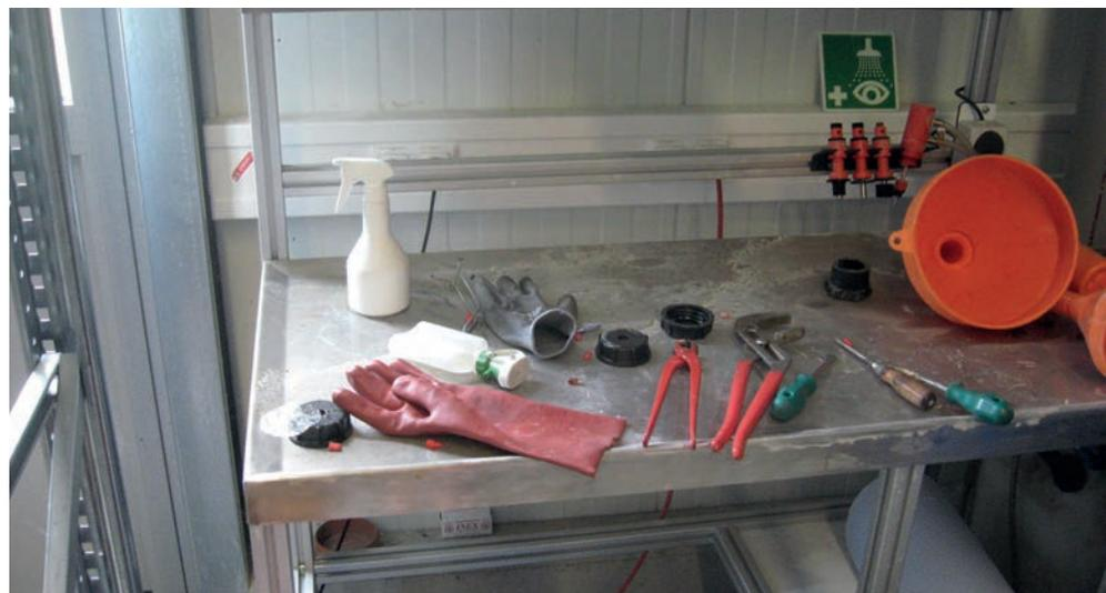
Bei Aufladen von Batterien entstehen gefährliche Gase (Knallgase), die bei vorhandenen Zündfunken zu gefährlichen Explosionen führen können. Deshalb gilt absolutes Rauchverbot in solchen Bereichen, so wie die Vermeidung sämtlicher Funkenbildung z. B. durch Flexarbeiten u. ä. Eine gute Belüftung dieser Bereiche verhindert die Ansammlung konzentrierter Knallgasmengen.
