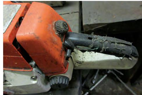
Beim unkonzentrierten Arbeiten mit der Motorsäge besteht die Gefahr, dass auf plötzliche Bewegungen von Holz oder Säge nicht rechtzeitig reagiert werden kann. Gerade bei einem Stechschnitt ist die Gefahr eines Kickbacks besonders groß, bei dem die Motorsäge rasant hochschnellt und den/die Motorsägenbedienenden treffen könnte.
