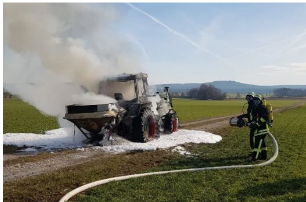
Schlepperbrand durch elektrischen Defekt Bildquelle: Feuerwehr Merkendorf
