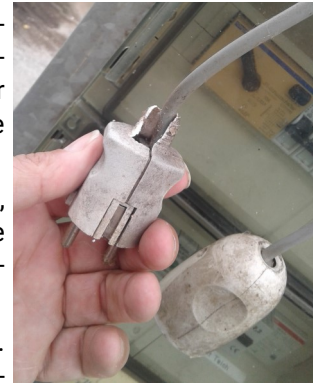
Durch UV-Licht versprödeter Kunststoff-Stecker Bildquelle: SVLFG
