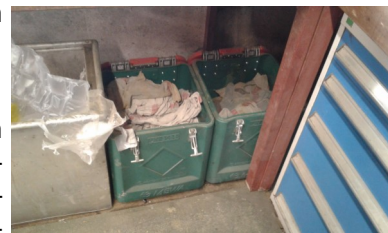
Sammelbehälter für betriebsmittelgetränkte Putzlappen falsch aufgestellt. Die Deckel können nicht verschlossen werden. Bildquelle: SVLFG
