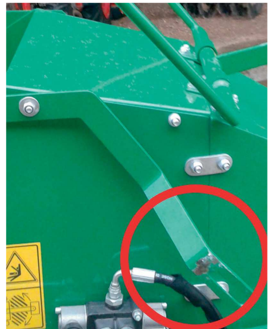
Nachträgliche Veränderung an einem Buschholzhacker: Der Sicherheitsbügel wurde durch Einbau eines neuen Mehrwegeventils unbrauchbar gemacht
